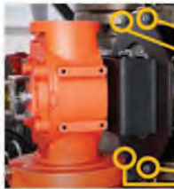
รูปที่ 1 ชี้นำให้เห็นขั้นตอนที่ยึด แทนของ actuator เข้ากับ ตัววาล์ว
